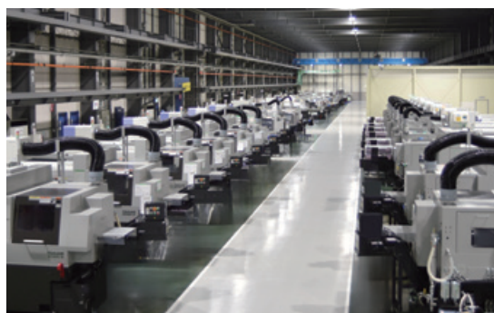
主軸移動型自動旋盤の生産ライン
